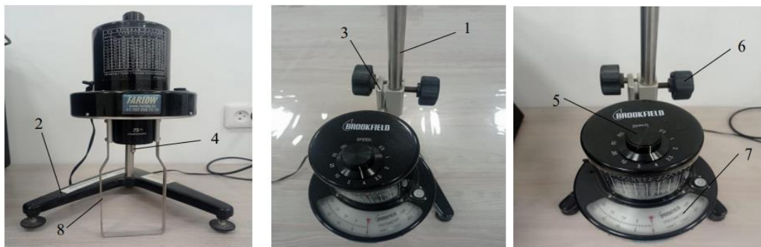
Сурет 4. Дөңгелек шкаласы бар Брукфилдтің аналогтық вискозиметрі
