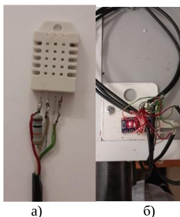
Рисунок 1. Установка и распиновка датчика DHT22 (а) и контроллера Arduino Nano 3.0 (ATmega328) (б)
