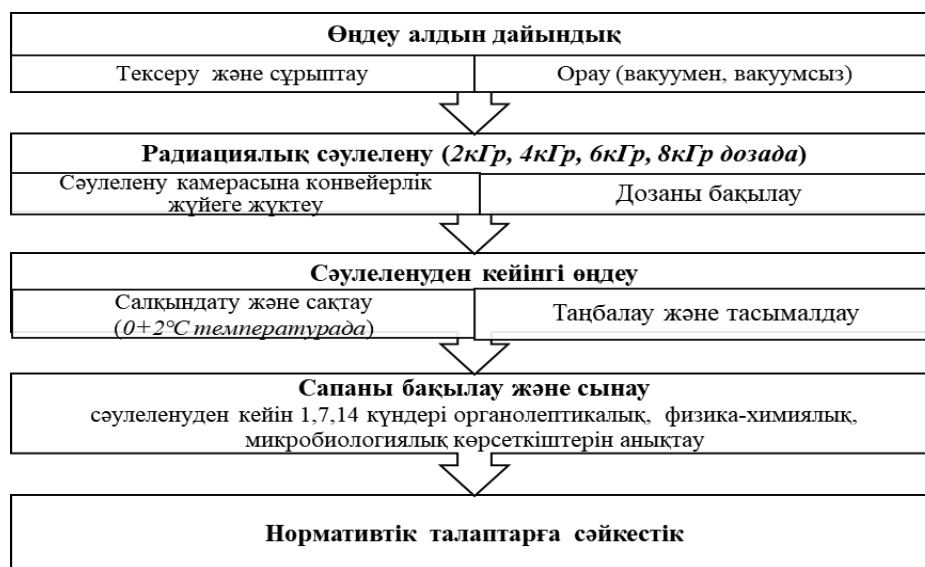
Сурет 1. Гамма сәулелендірумен құс етін өңдеудің оңтайлы режимде жүргізген технологиялық схемасы
