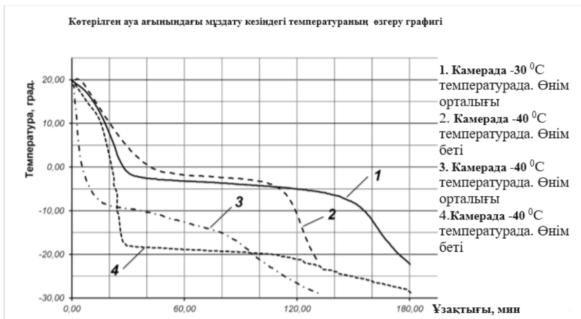
Сурет 2. Жоғары ауа ағынында мұздату кезіндегі температураның өзгеру графигі
