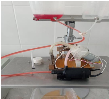
Сурет 2. Шашырату әдісімен капсулалауға арналған жетілдірілген қондырғы
