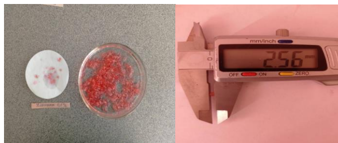
Сурет 10. Шашырату әдіспен 0,5 % альгинат концентрациясында алынған капсула
