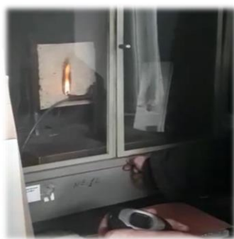
Сурет 4 – «ОВТ» құрылғысында бейматаның жануға төзімділігін сынау
