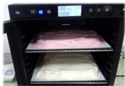
Рисунок 1а- Процесс сушки белковой пастилы в дегидраторе
