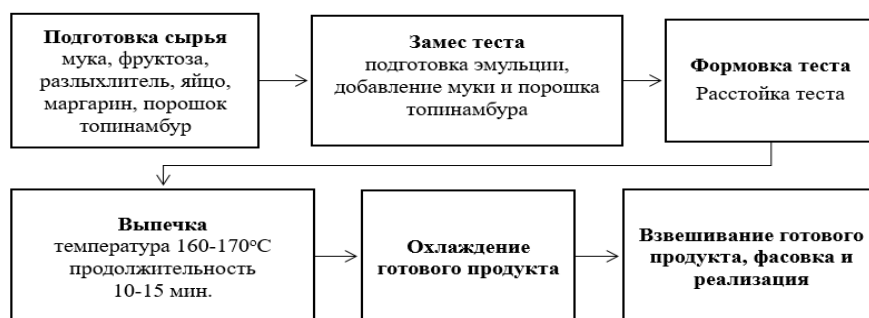
Рисунок 1 – Блок-схема производства печенья с добавлением концентрата топинамбура
