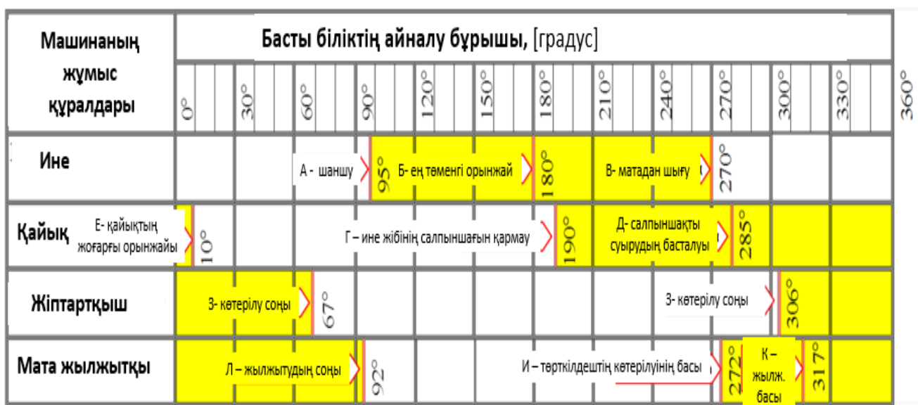
Сурет 3. TYPICAL GC6150 тігін машинасының жұмыс құралдарының өзара қатынастарын көрсететін циклдік диаграмма.
