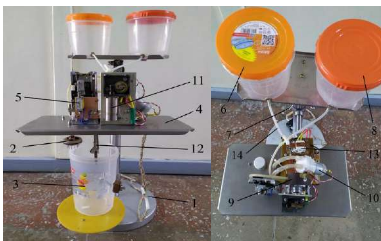
Рисунок 2 - Установка для инкапсулирования пробиотиков: 1-штатив, 2- фильера, 3- емкость для раствора, 4- панель исполнительных устройств, 5- встряхиватель, 6 – емкость для рабочей смеси, 7- гайка регулировки уровня емкостей, 8- емкость для промывной жидкости, 9- перистальтический насос, 10 – циркуляционный насос, 11 – мотор привода перистальтического насоса, 12- циркуляционная трубка; 13 – термостат; 14 - трубопроводы
