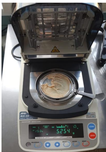
5-сурет – Тұзды қабықтың ылғалдылығын анықтау процесі
