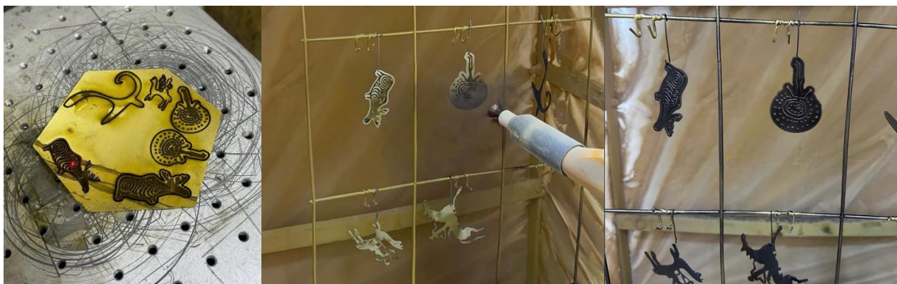
Сурет 2. Лазерлік кесу арқылы формаланып, ұнтақты бояумен қапталған жез
