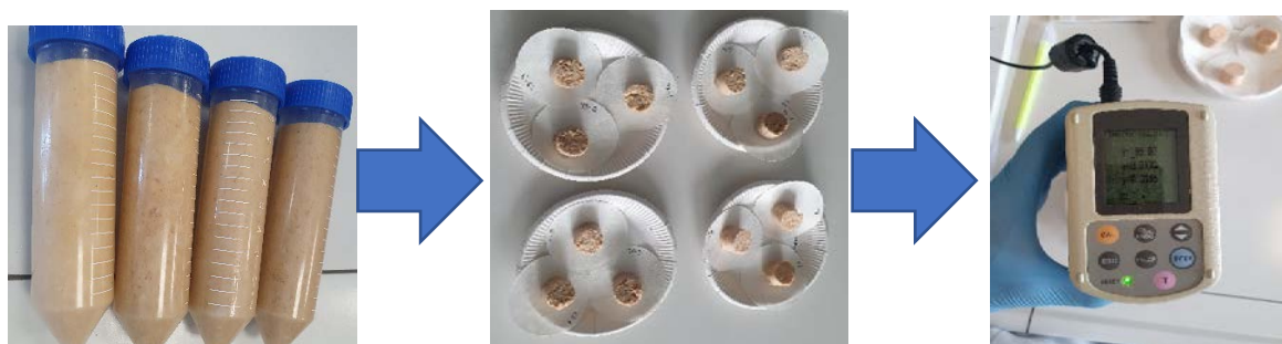
Сурет 1. Шұжық түсін колориметрмен өлшеу қадамдары
