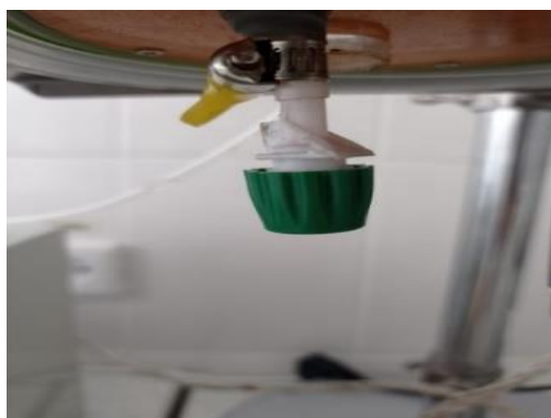
Сурет 3. Ортадан тепкіш форсунка d = 1,2 \times 10^{-3} \text{ м}
