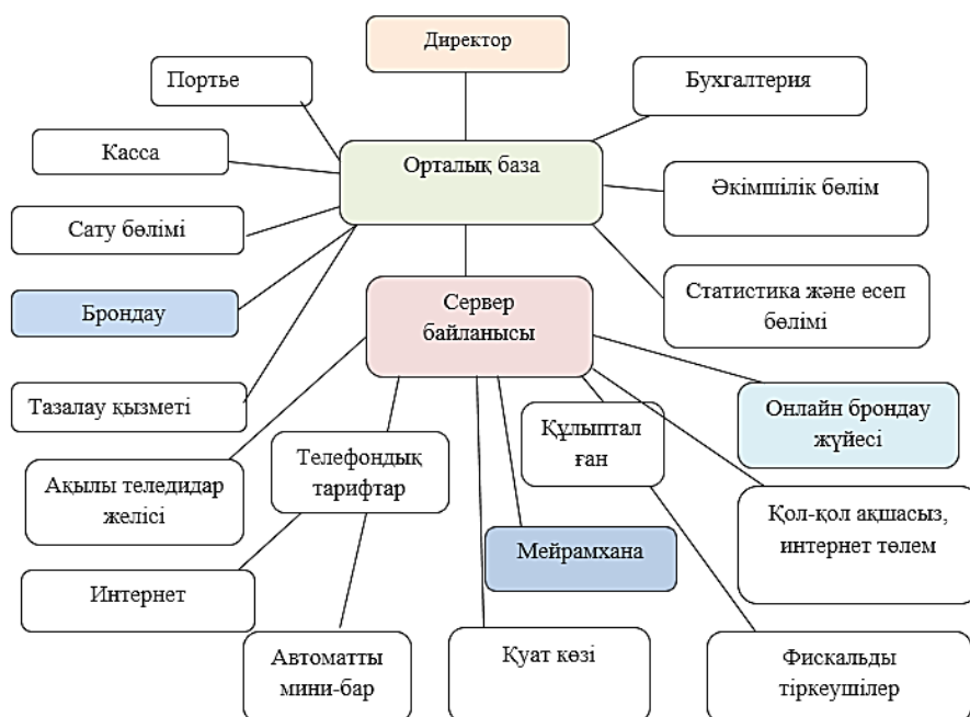
1 сурет - Модульдердің типтік құрамы және сыртқы HMS жүйесі *Ескерту - автормен [3]негізінде құрастырылған
