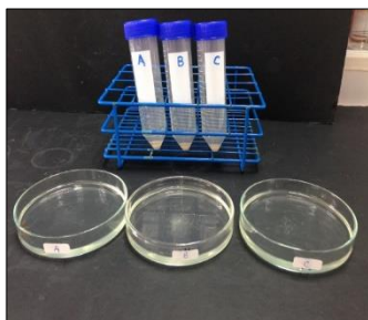
в) Надосадочную жидкость переносят в предварительно высушенную стеклянную чашку Петри
