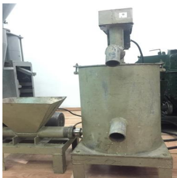
Рисунок 3 - Центрифуга для разделения жира от шквары.
