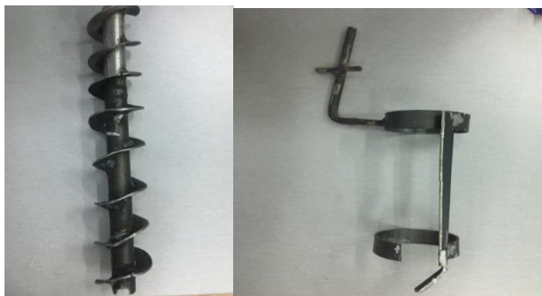
Рисунок 4 - Шнек и разгрузочный скребок
