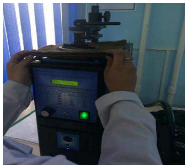
Рисунок 2 - Определение воздухопроницаемости пакета материалов
