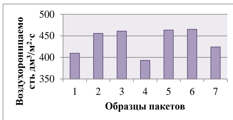
Рисунок 3 - Индикаторная диаграмма воздухопроницаемости пакета материалов
